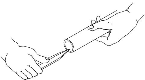
INSIDE EDGE OF THE PIPE MUST BE SLIGHTLY DEBURBED
