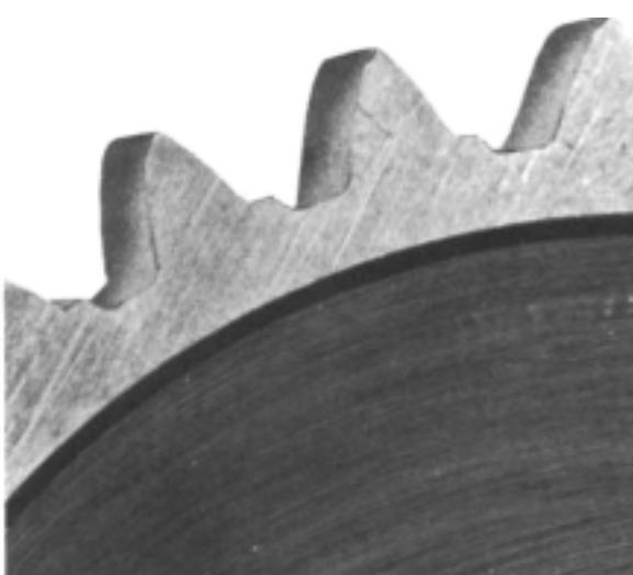
**कारण (Cause):** जब अपयनि लुब्रीकेट की परत धातु पर होगी तब वियर अधिक होगा। Wear in progress, in a dequate lubricant film
