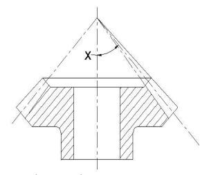
A : Pitch cone angleB : Root angleC : Face angleD : Shaft angle
